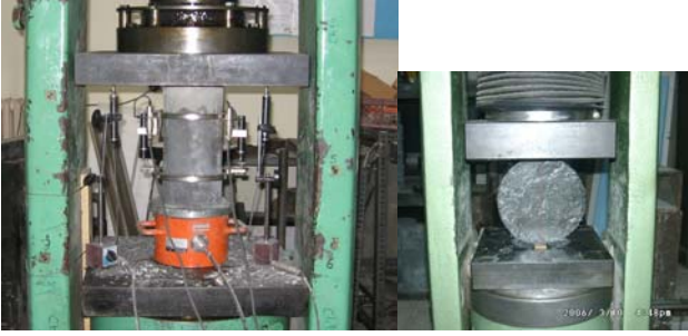
Şekil 4. Standart silindir basınç ve disk yarma çekme deneyleri
